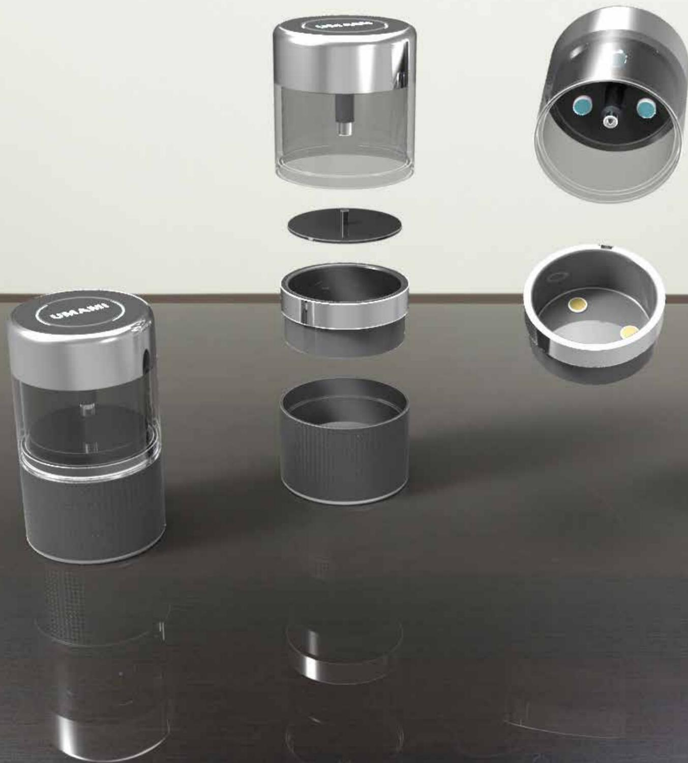
Der Sensor im «Nose» erkennt dabei nicht nur verschiedenste Gerüche und Geschmäcker wie süß, salzig, fruchtig, erdig etc., sondern auch die Konsistenz des Gerichtes. Mit Hilfe eines Algorithmus werden diese verschiedenen Daten zu einem Bild zusammengetragen.
